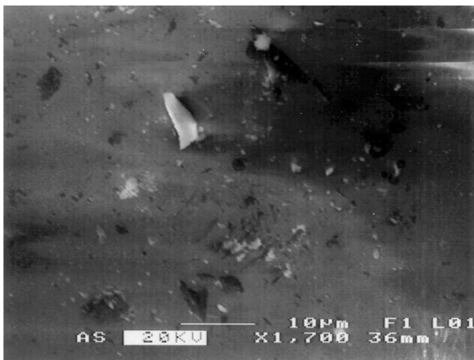
Imagen 6: hormigón con AF, estructura densa y cerrada
