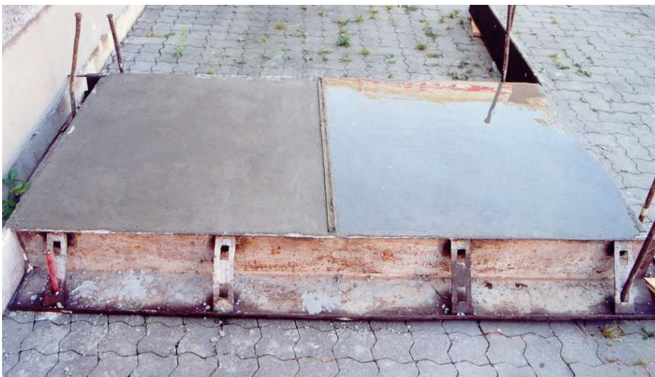
Imagen 1: placa, a la izquierda sin AF, a la derecha con AF aplicado
