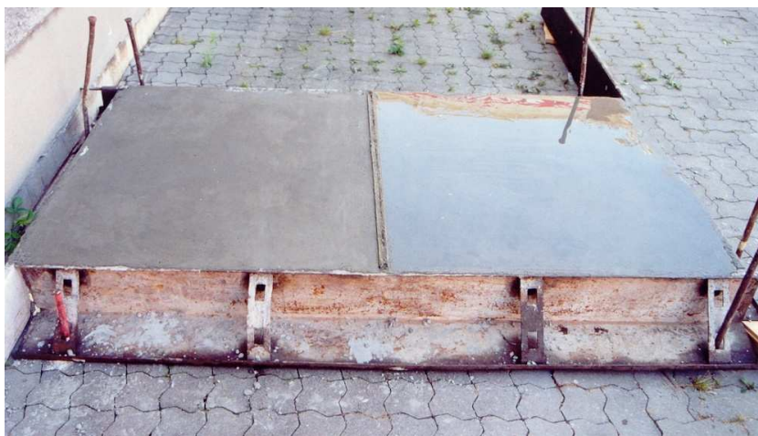
Рис. 1. Плита для испытаний: слева – необработанная, справа – обработанная Ашфорд Формулой
