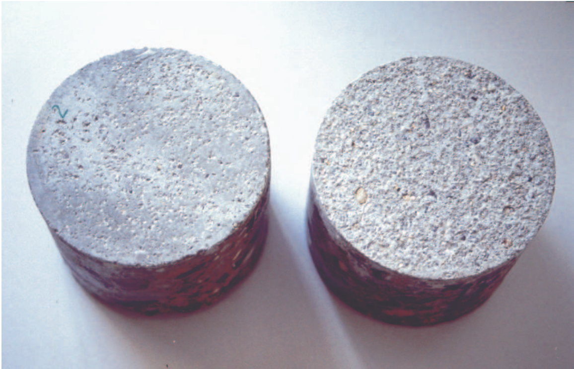
Рис. 2. Поверхность бетона после воздействия циклического замораживания и оттаивания в солевом растворе
